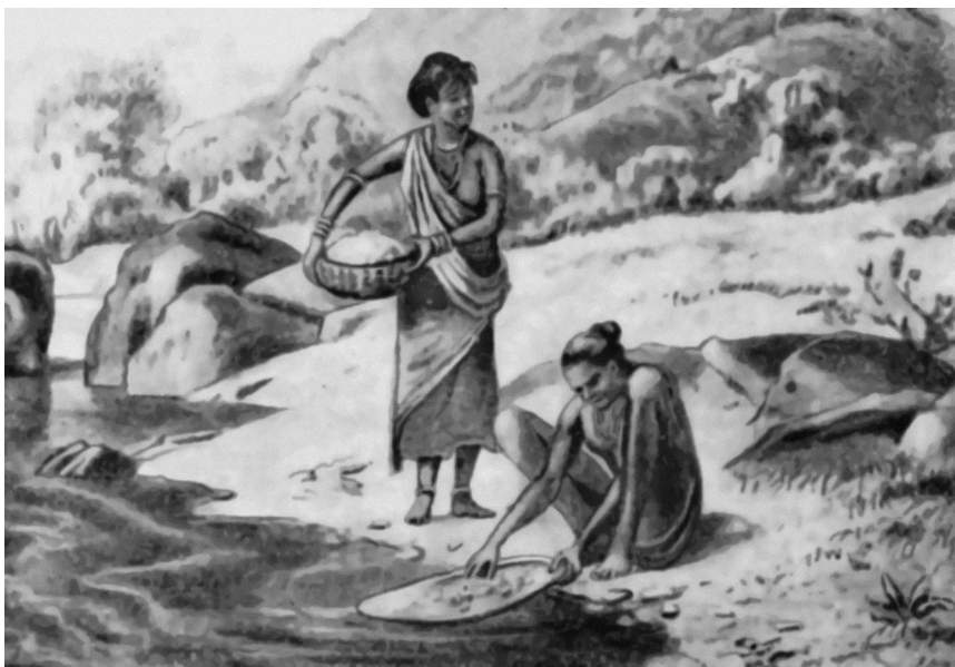
Рис. 59. Промывка золота в речном песке в Сингбумо, Индия. По Боппу, 1881
