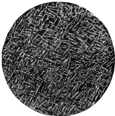
Рис. 2. Строение силлиманита.
